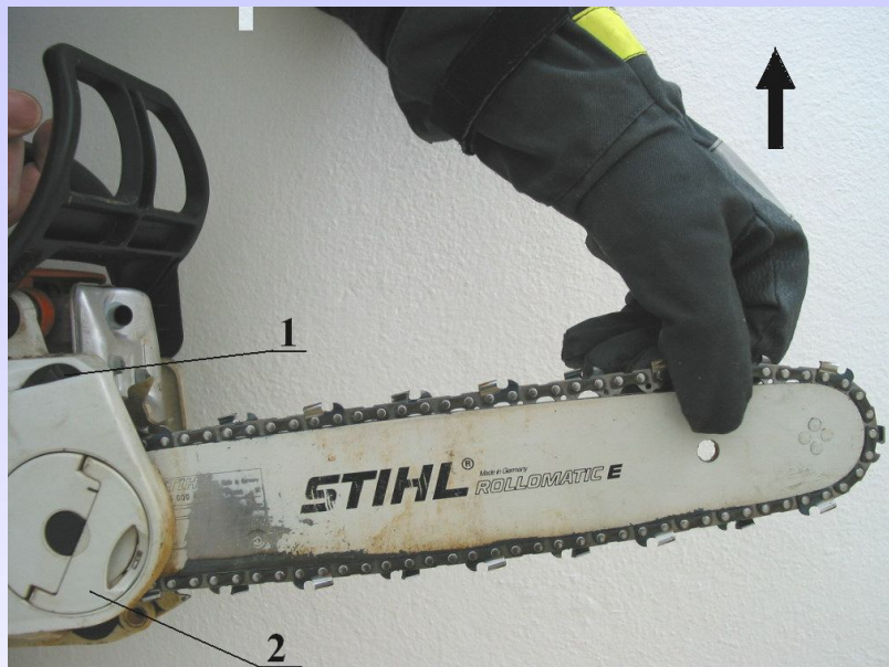
Prawidłowe napięcie łańcucha.
