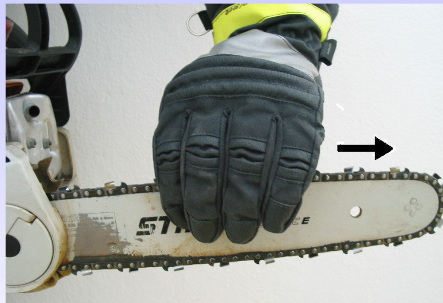
Sprawdzanie płynności ruchu łańcucha tnącego.
