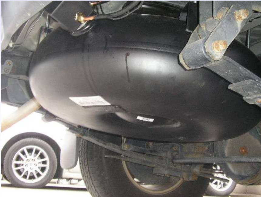
zbiornik o przekroju toroidalnym pod pojazdem
