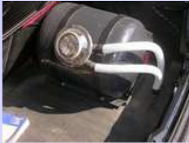
zbiornik o przekroju walcowym w bagażniku
